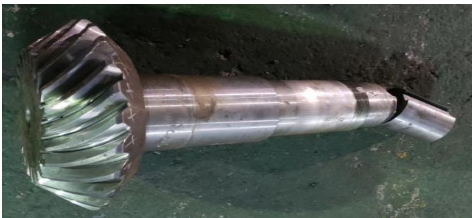
Fig-7: Cabezal de engranaje cónico helicoidal de eje que falló.
